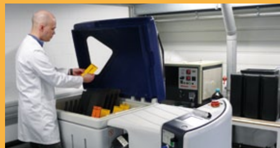
Salzsprühtest nach DIN EN ISO 9227
